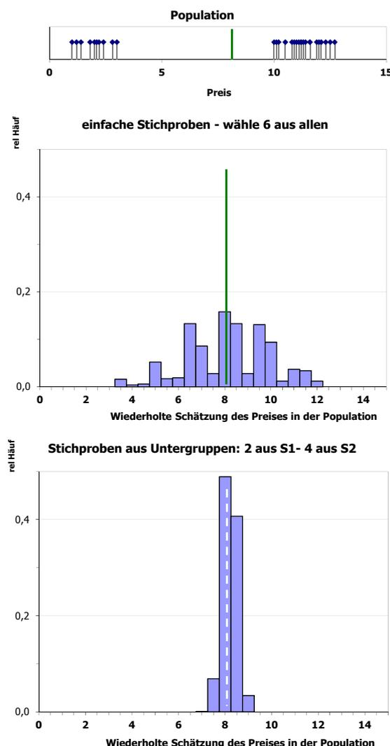
Abb. 8: Wiederholte Schätzung des Preisniveaus bei einfachen und bei geschichteten Zufallsstichproben.
