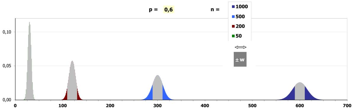
Abb. 6: Divergenz der absoluten Häufigkeiten: Wenn die Zahl der Experimente zunimmt, verbleibt mehr und mehr Wahrscheinlichkeit außerhalb des Fensters mit fester Breite  $\pm w$ .
